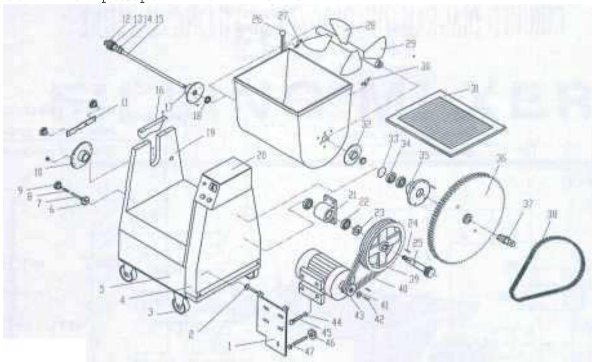
Рис. Вид машины в разобранном состоянии
